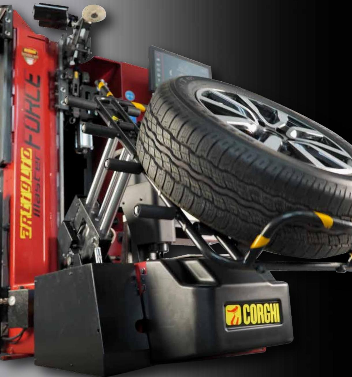
Monte/démonte-pneus hydraulique avec système Contactless Smart automatique.
