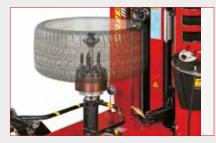
Flangia per ruote a canale rovescio Reverse wheel flange 8-11100039
