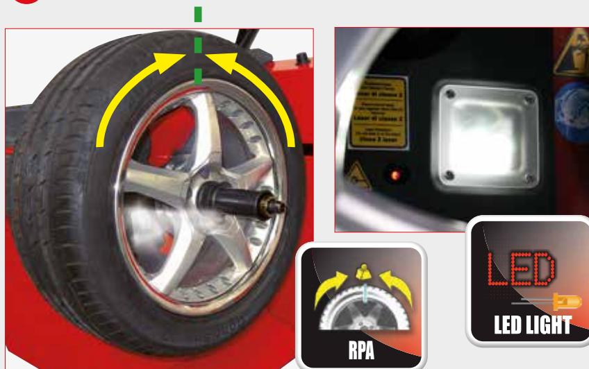
À la fin du lancement la roue est freinée et placée automatiquement en position d'équilibrage (RPA).
