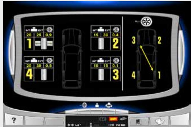
**Spezielles Diagnoseinstrument** für den Reifensatz des Fahrzeugs zur Kontrolle der Exzentrizität und Unwuchten. Wurden alle Räder gespeichert, schlägt die Auswuchtmaschine vor, wie sie am besten am Fahrzeug positioniert werden sollten, um den Komfort und die Sicherheit des Fahrzeugs zu begünstigen. Vollständige Diagnose bei vorhandenem Sonar Runout.
