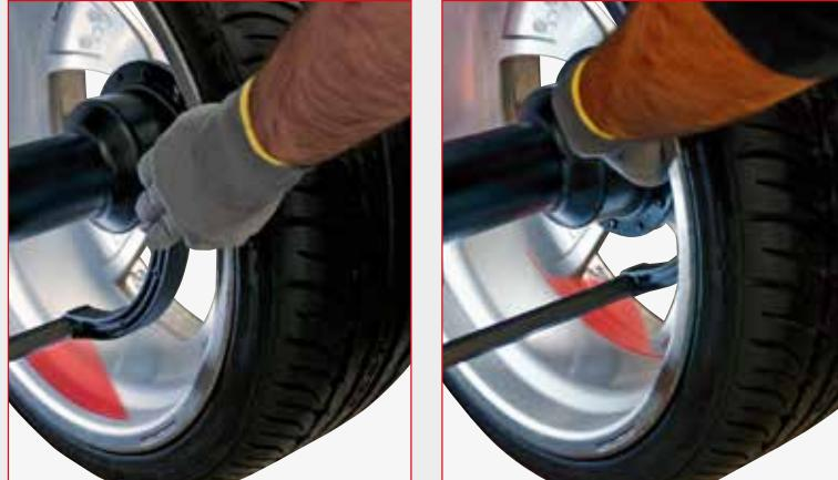
Neue digitale Messlehre für Durchmesser- und Abstandmessung mit integrierter FSP (Fast Selection Program) Funktion und neuem, integriertem LaserBlade Pointer: die Funktion FSP aktiviert automatisch die Auswuchtprogramme und erfordert deshalb keine Wahl über die Tastatur mehr. Der LaserBlade Pointer (im Messarm) unterstützt den Bediener bei der Wahl der Innenflächen der Leichtmetallfelge - fehlerfrei und mit extrem gutem Sichtfeld.
