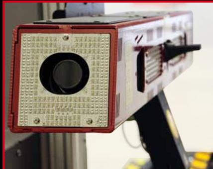
Distanciómetro láser para búsqueda puente y rueda
