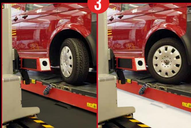
Misura parametri sterzo - ruota
